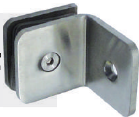
Conector 223 90° V/A AÇO INOX 304 escovado Para vidros de 8 a 10 mm Cód: 02.26.202
